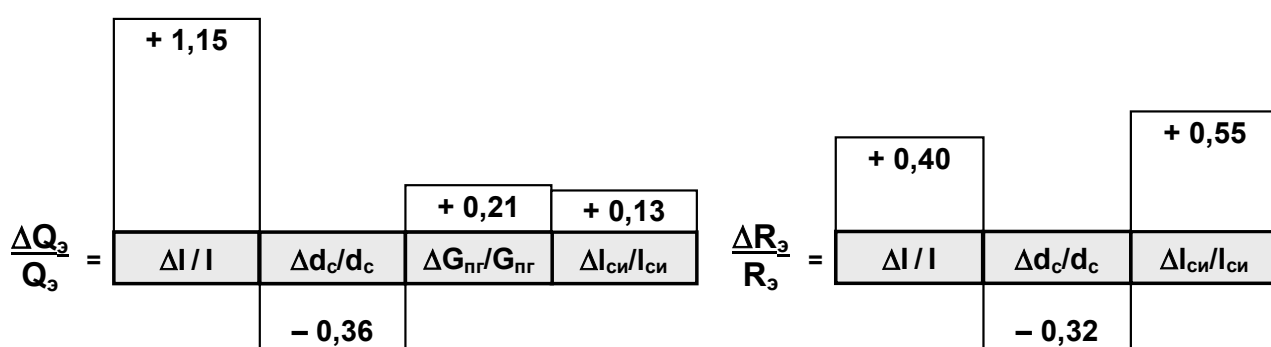
Рис. 3. Связь эффективной мощности и эффективного радиуса сжатой дуги с параметрами режима плазменной закалки.
