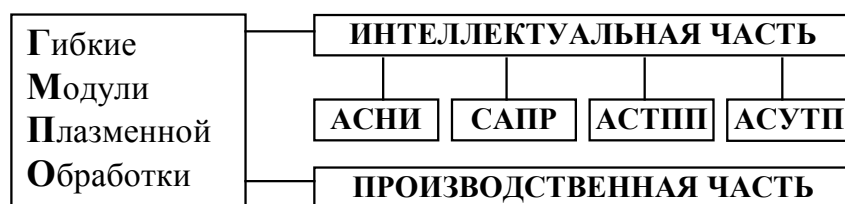
Рис. 1. Структура гибких модулей плазменной обработки (ГМПО).
