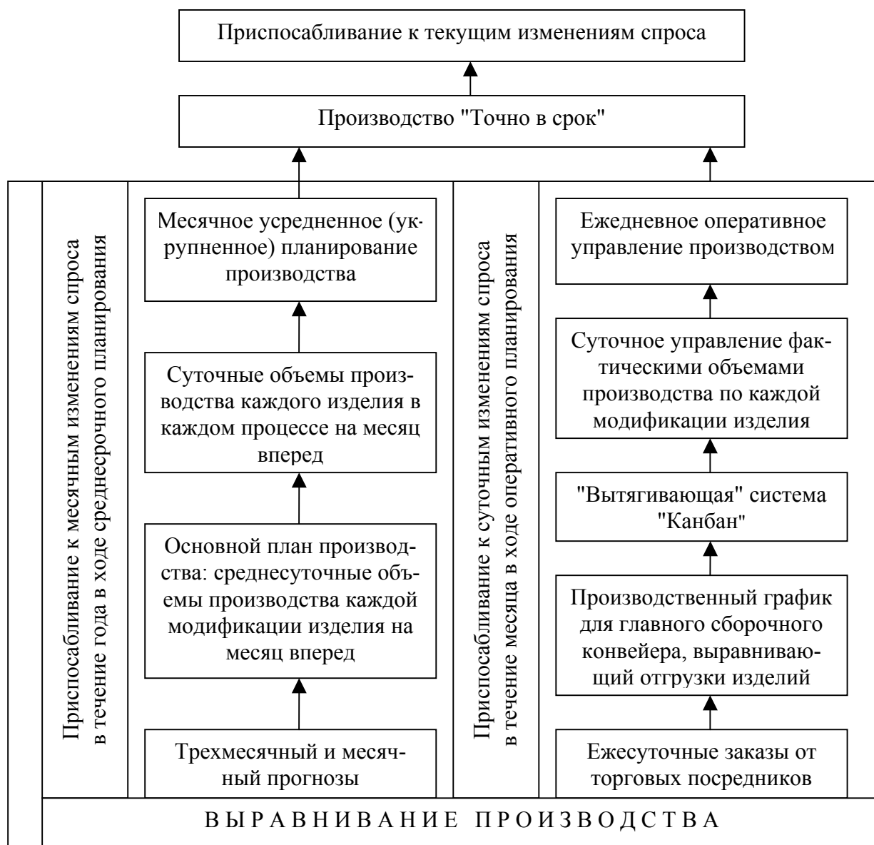
Рис. 18. Схема "выравнивания" объемов производства в системе "Тоёта"
