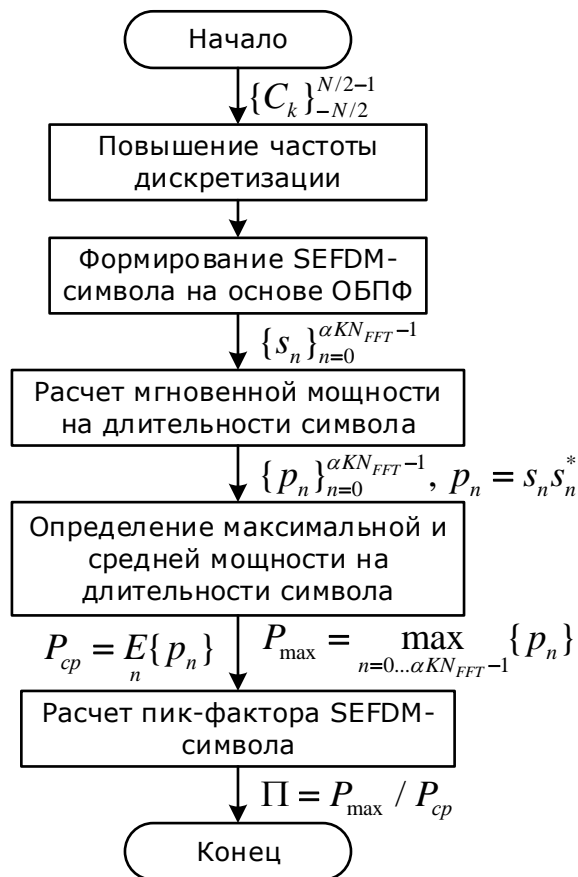
Рис.4. Блок-схема алгоритма расчета пик-фактора одного OFDM- или SEFDM-символа
