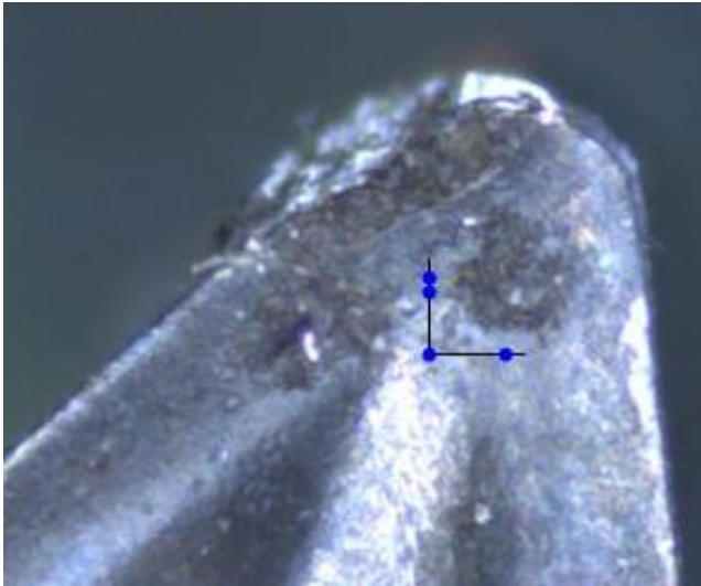
Рисунок 3 – Состояние режущей кромки пластины DNMG 150404-SF H13A V = 160 м/мин, R нет – скол
