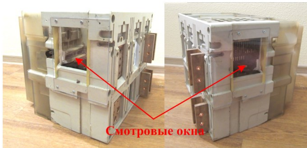
Рисунок 26 – Смотровые окна для высокоскоростной съемки
