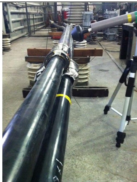
Рис. 11 Кабельная линия, проложенная треугольником встык
