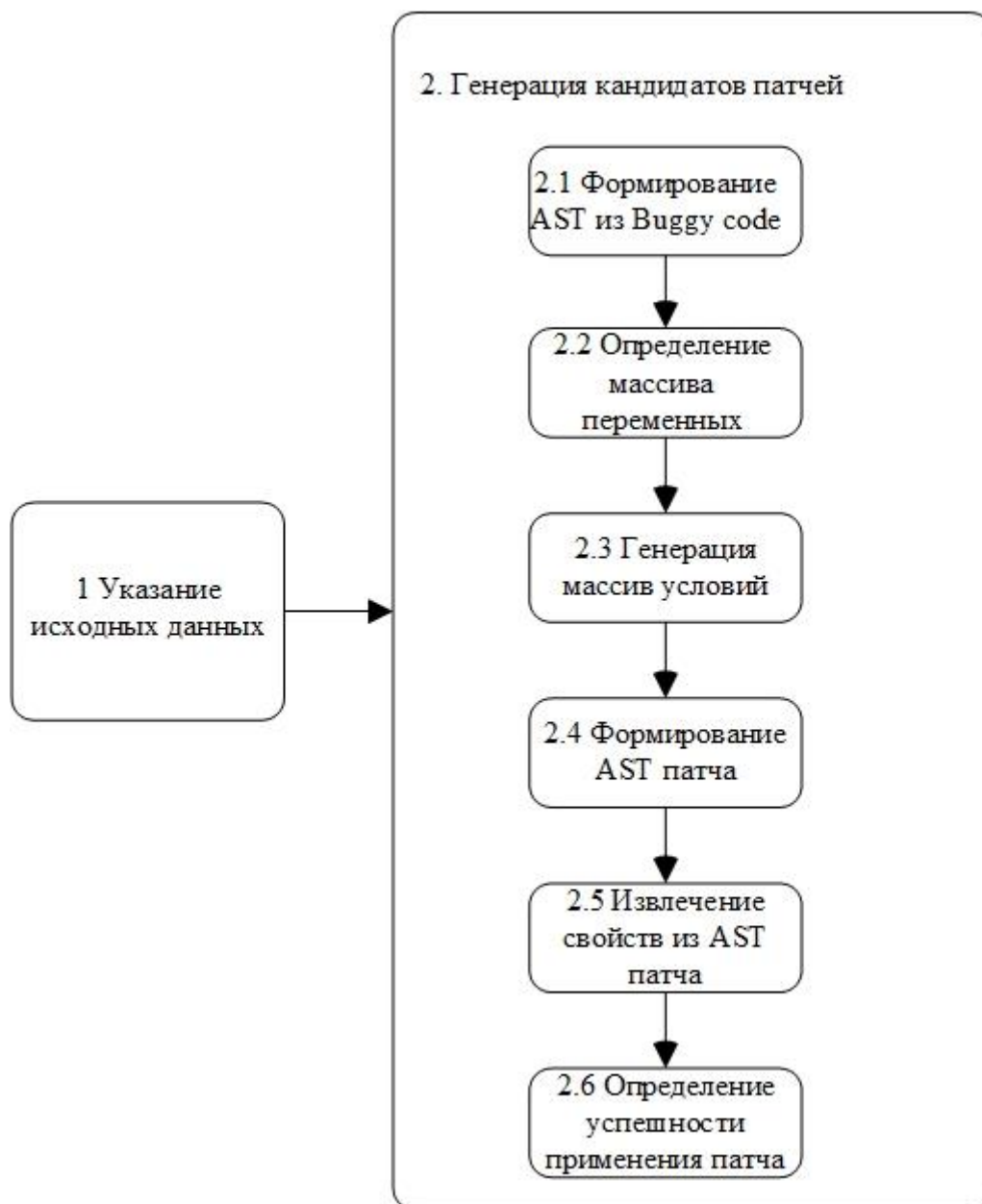
Рисунок 4.5 Алгоритм работы функционального блока генератор патчей (Patch generator) оконного приложения
