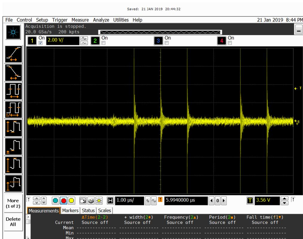
Рис. 9. Последовательность сгенерированных СШП импульсов
