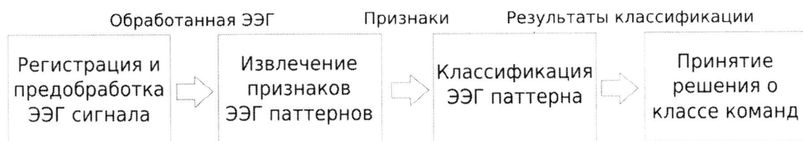
Рисунок 1. Обобщенная схема ИМК на базе ЭЭГ сигнала
