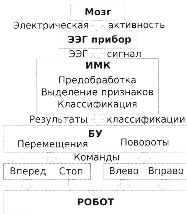
Рисунок 4. Структура системы управления мобильным роботом с применением интерфейса «мозг-компьютер»
