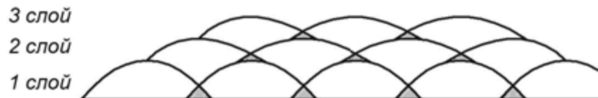
Рис. 23. Схема многослойной наплавки
