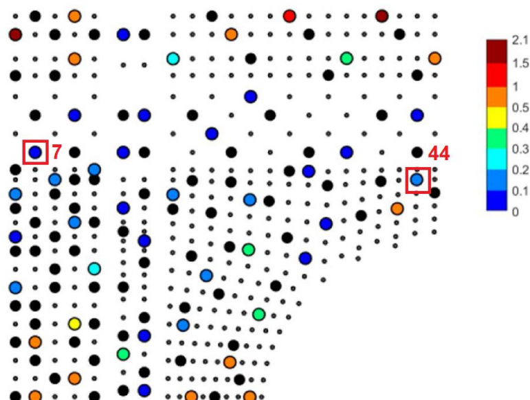
Рисунок 40 – зазоры в рассверливаемых отверстия при использовании начальной расстановки
