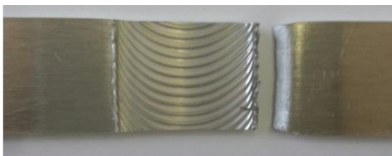
Рисунок 18 – Место разрушения СТП и ИСТП соединений
