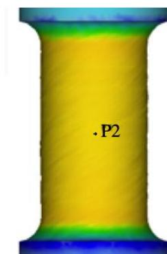
Рис. 46. Расчетная точка P2 на поверхности образца для получения уровня значений напряжений и деформаций
