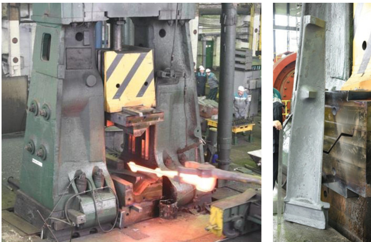
Рис. 6. Штампованная заготовка турбинной лопатки из стали 15X11МФ-Ш
