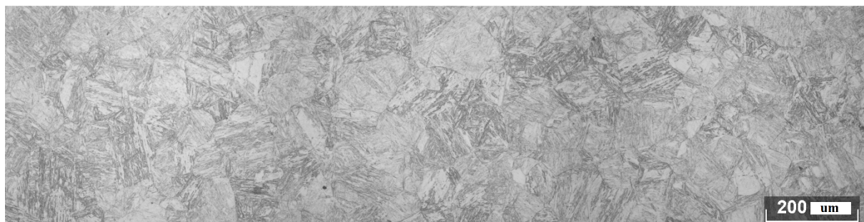
Рис. 5. Типичная микроструктура штампованной заготовки в зоне профиля пера
