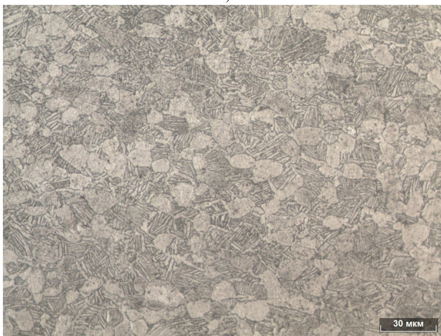
Рис. 13. Микроструктура образца а) – отжиг, б) – закалка с отжигом
