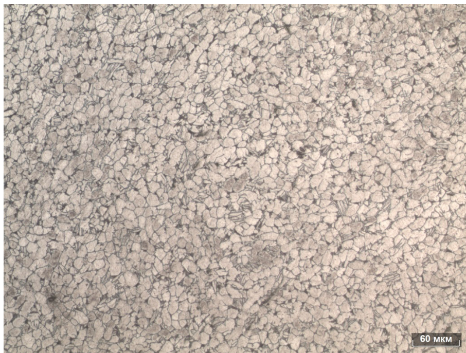
Рис. 12. Пример микроструктуры в поперечном сечении исходного прутка
