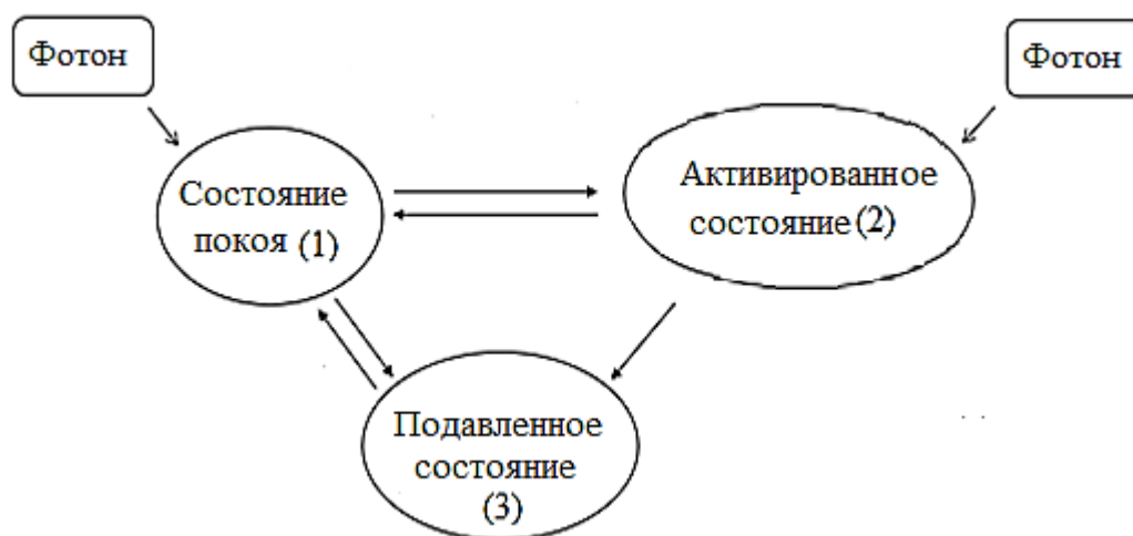
Рисунок 1.4 – Схема переходных состояний PSF
