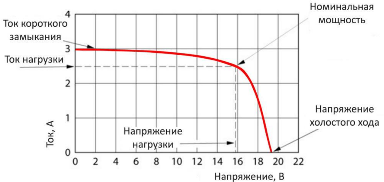
Рис. 11. Типичная вольтамперная характеристика построенная на основе однодиодной модели, учитывающей сопротивление шунта.
