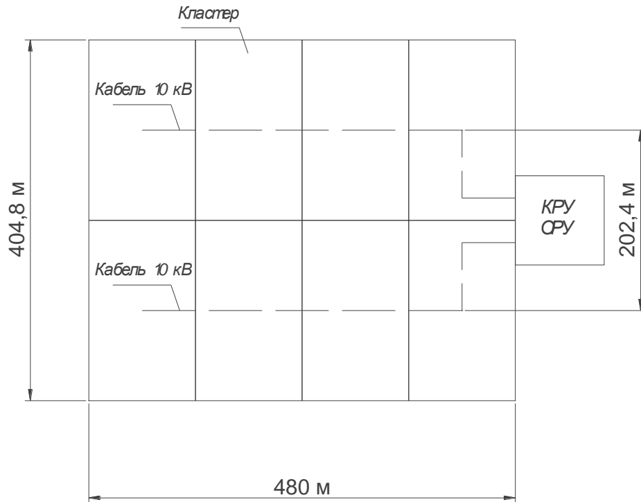
Рис. 26. Схема солнечной электростанции с центральным инвертором.
