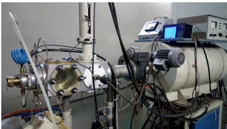
Рис. 1. Мишенное устройство циклотрона МГЦ-20
