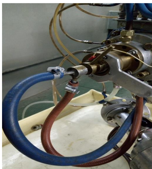
Рис. 2. Система водяного охлаждения медной мишени, синий шланг - подача воды, красный шланг - отвод воды
