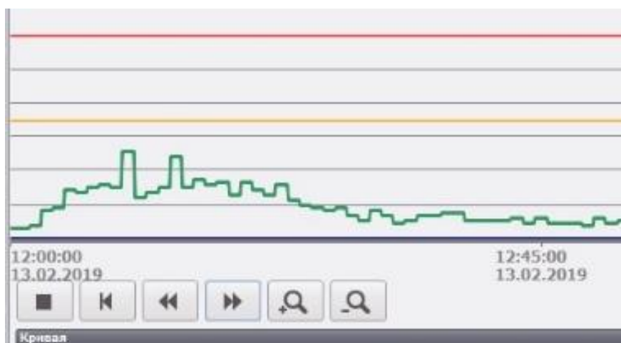
Рис.34. Показания регистратора нефтяных пленок.
