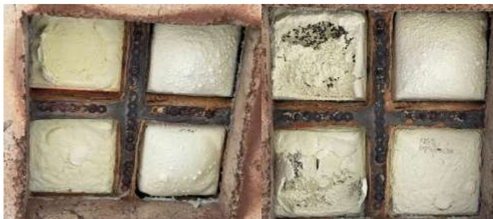
Рисунок 9. Вид пенококсовых слоев после проведения огневых испытаний по модифицированному контрольному методу ГОСТ 53295-2009
