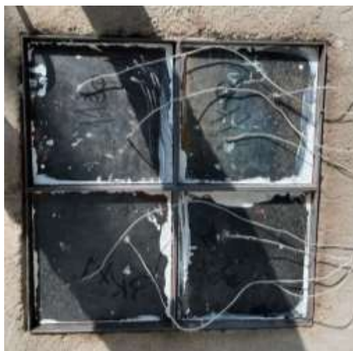
Рисунок 8. Расположение рамки держателя вместе с испытываемыми образцами и смонтированными на них термопарами в печи, вид с необогреваемой стороны
