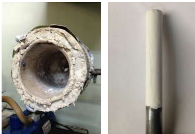
Рисунок 11. Установка «асбестовая труба» и образец для испытаний
