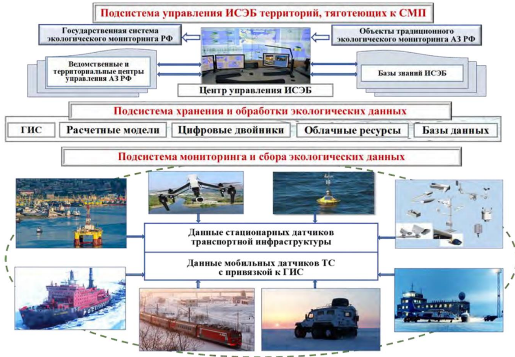
Рисунок 1. Архитектура интеллектуальной системы управления экологической безопасностью для СМП
