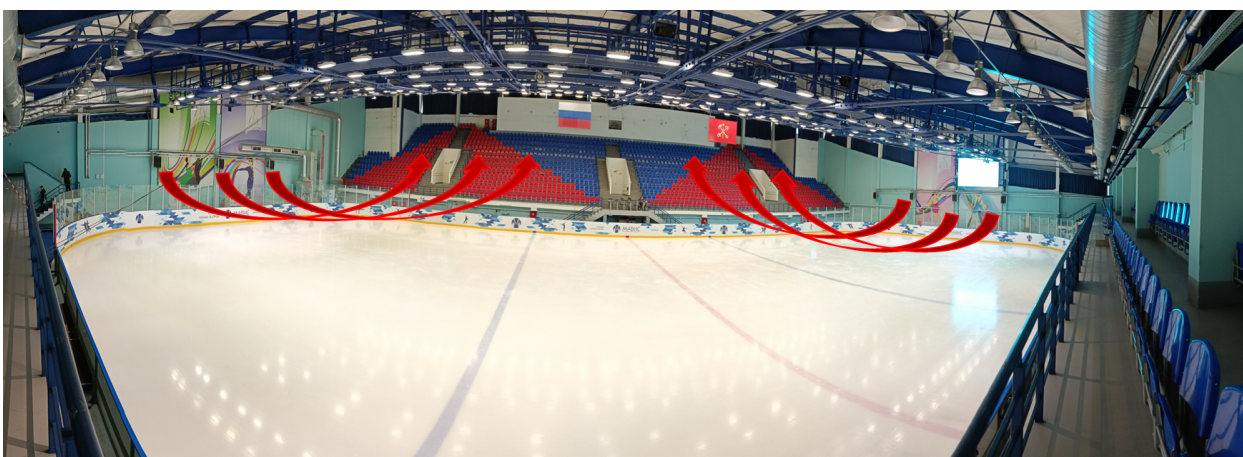
Рисунок 2.3 – Схема распределения воздушных потоков тепловентиляторов над ледовой ареной
