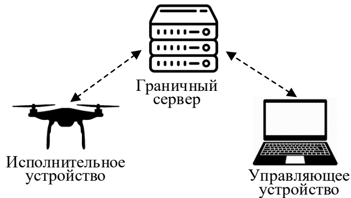
Рисунок 2 – Модель взаимодействия двух устройств ИВ в рамках протокола аутентификации в граничной вычислительной архитектуре
