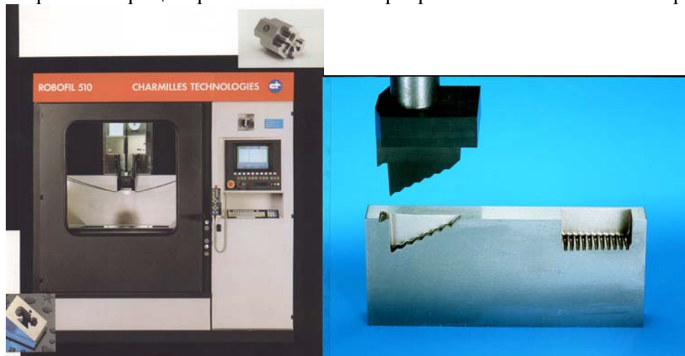
Вырезка матрицы проволокой на электроэрозионном станке и его структура
