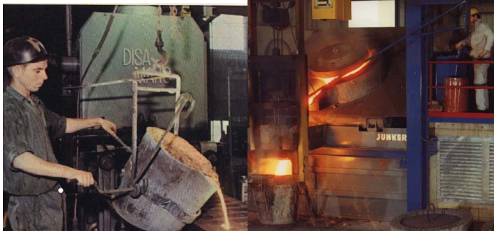
Заливка форм жидким металлом
