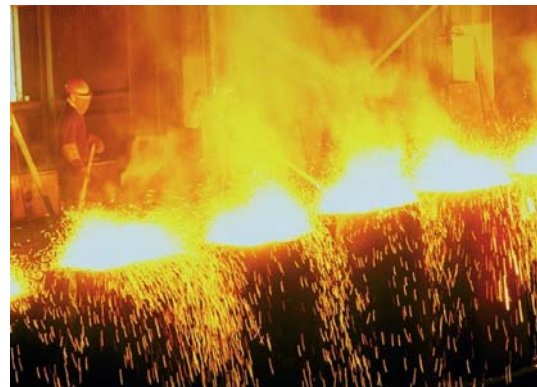
Разливка стали в формы для слитков
