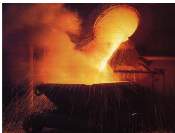
Выгрузка готовой стали из конвертора
