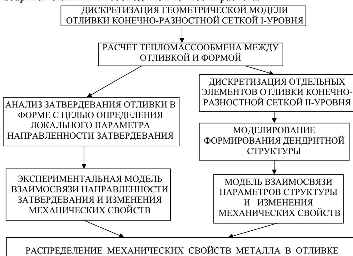
Рис.1 Комплекс моделей для расчета распределения механических свойств металла отливки
