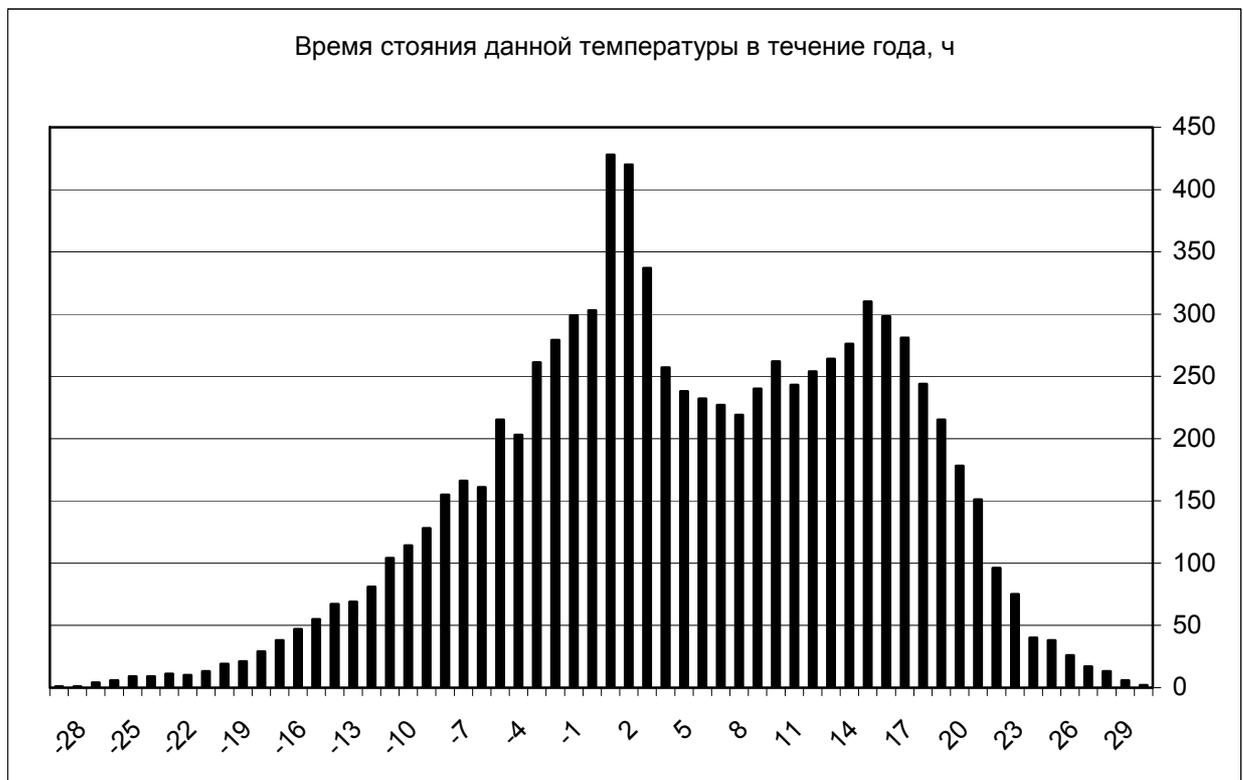
На графике виден максимум времени стояния в области нуля градусов вызванный энергоемкостью фазового перехода «лед-вода» для атмосферной и поверхностной воды.
