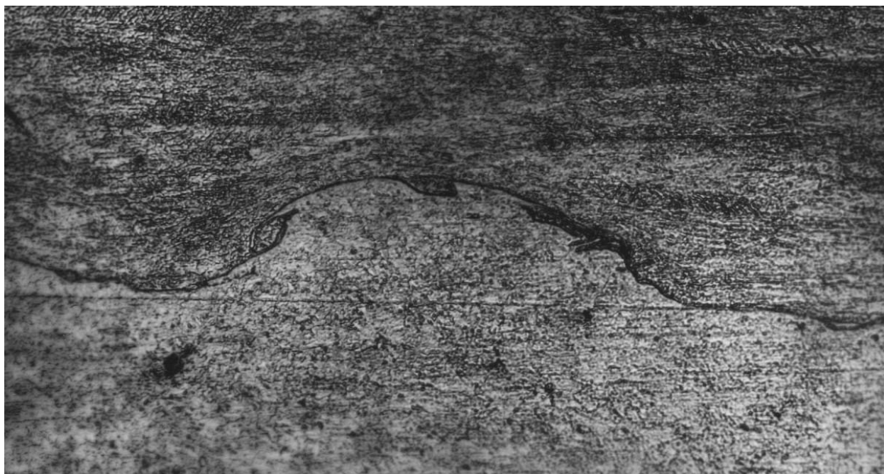
Рис. 10. Волна сварки увеличение \times 500
