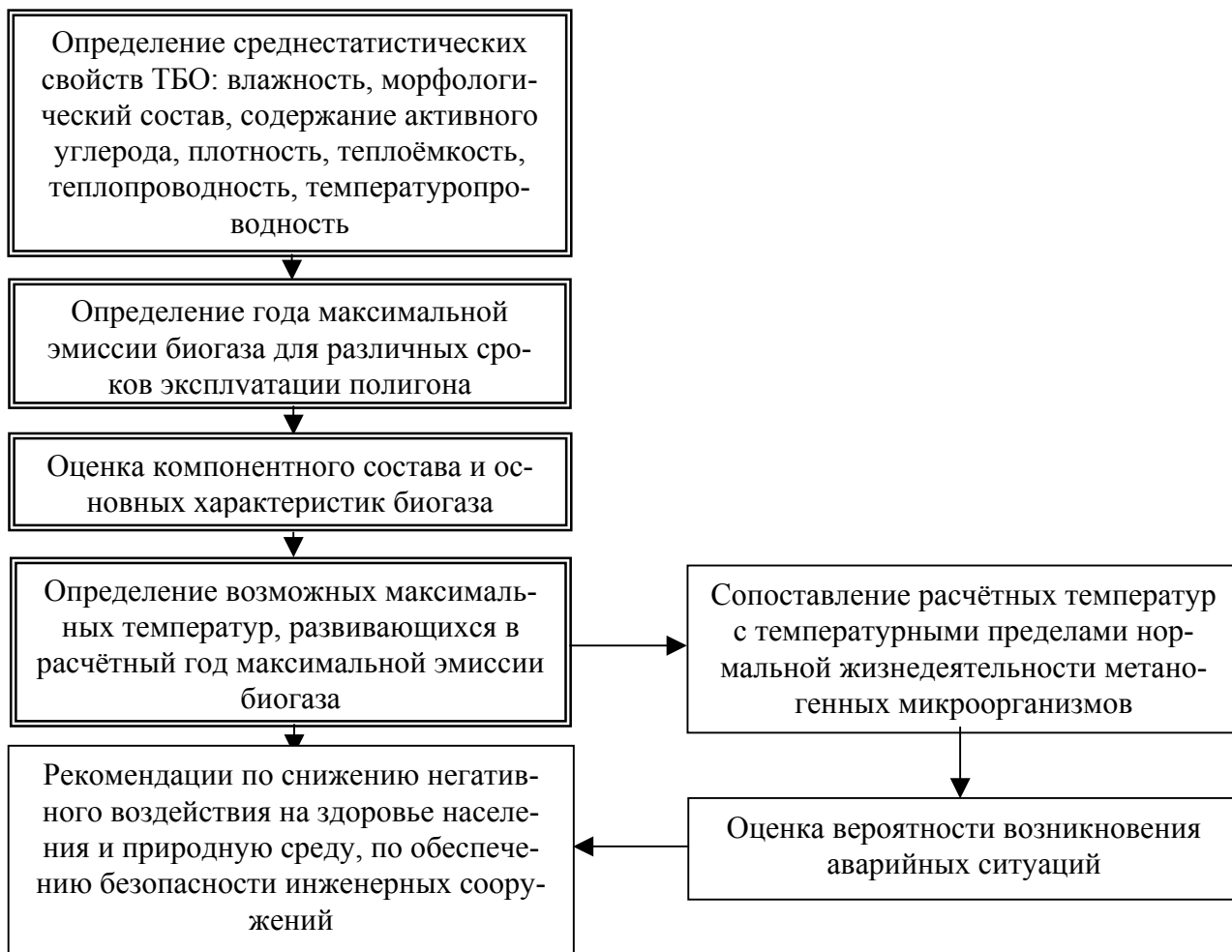
Рис. 2. Блок-схема алгоритма методики расчёта теплового режима полигонов ТБО (двойной линией выделены главные расчётные блоки)
