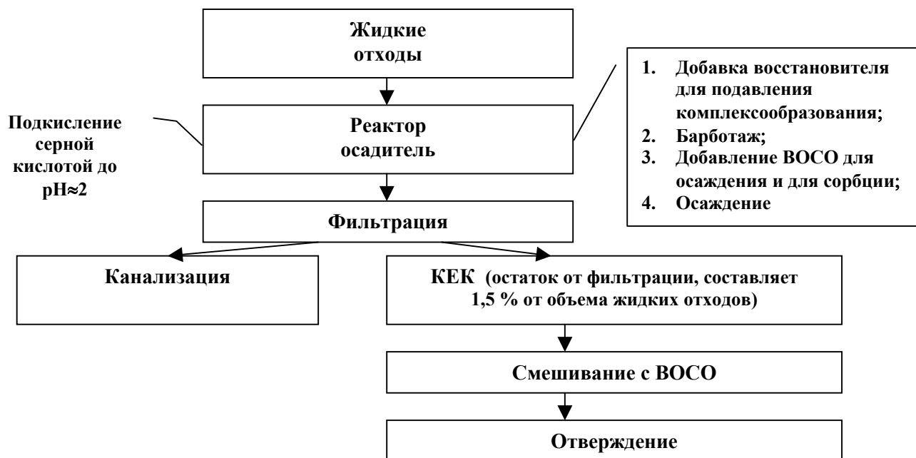
Рис. 4. Схема проведения процесса ступенчатой иммобилизации опасных примесей Полигона «Красный Бор»
