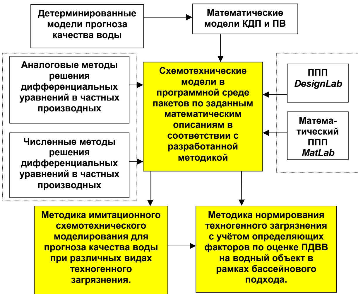
Рис. 2. Общая структура схемотехнического имитационного моделирования задач КДП и ПВ
