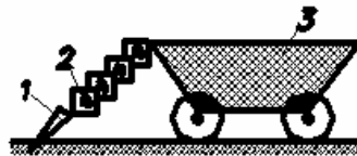
Рис. 1.1.3. Корчеватель-бульдозер-погрузчик КБП-2 ( d_k < 100 см)
