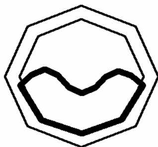
Рис 4.4.1. Прокладка жесткой сплющенной трубы внутри старой
