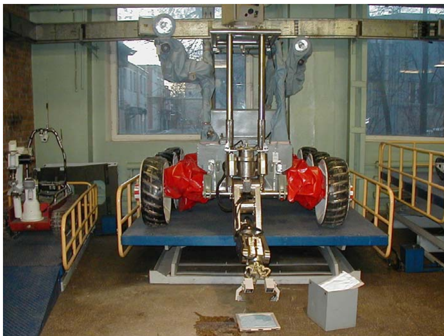
Фото 2. КРТ-100М с манипулятором РМ-02 и гамма-локатором на испытаниях впитывающих захватов.
