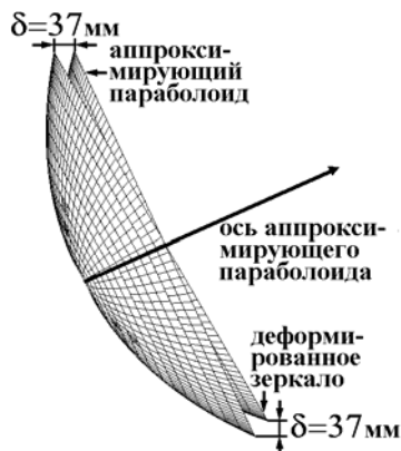
Рис. 16. Сравнение деформированного зеркала и аппроксимирующего параболоида (увеличено в 75 раз)
