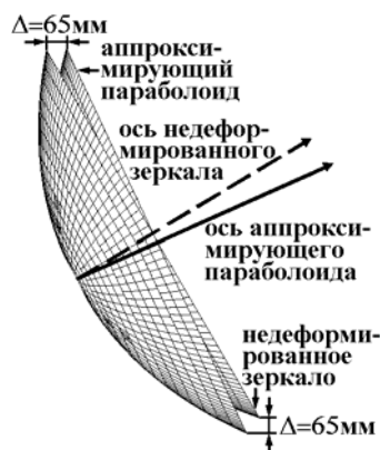
Рис. 15. Сравнение недеформированного зеркала и аппроксимирующего параболоида (увеличено в 40 раз)
