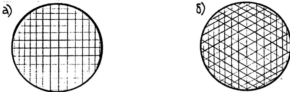
**Рис. 3.16.** Двухпутное (а) и трехпутное (б) размещение преднапряженных армоэлементов в куполе (вид сверху)
