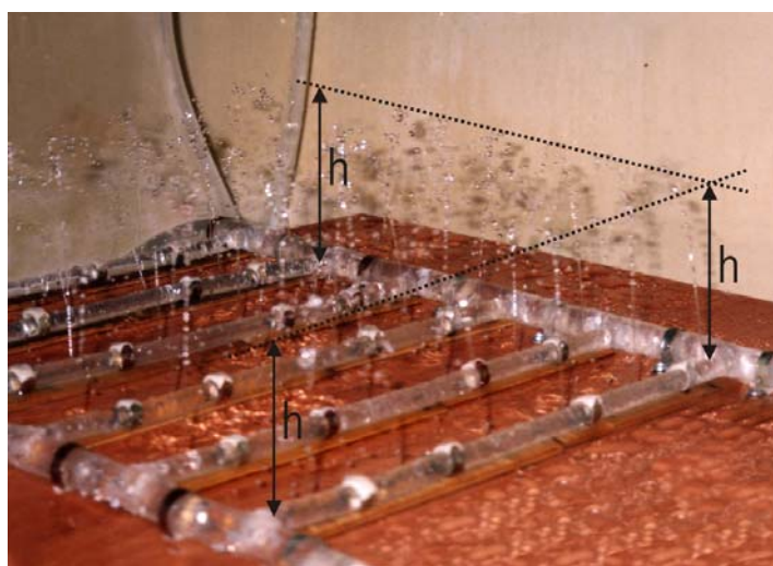
Рис. 4. Работа модели фрагмента замкнутой системы водораспределения
