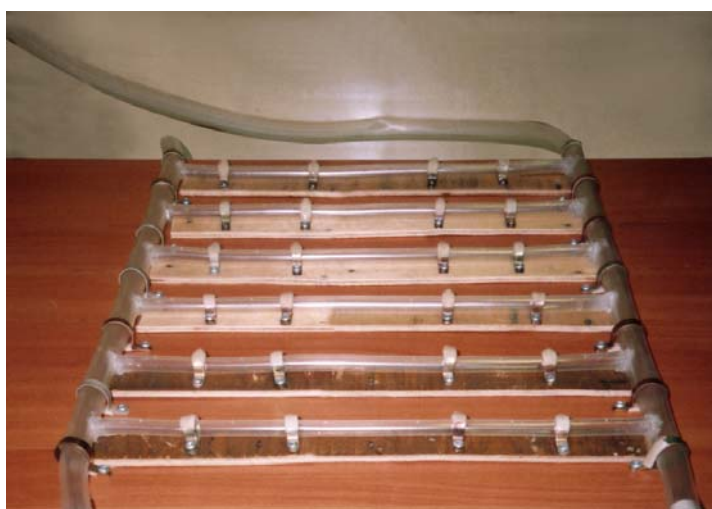
Рис. 3. Модель фрагмента замкнутой системы водораспределения
