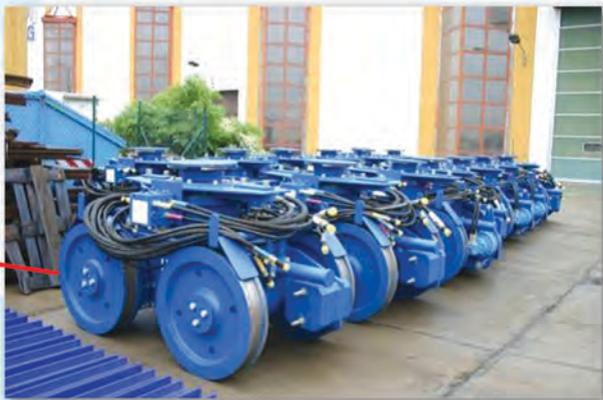
**Рис. 6.** Самоходные кильблоки: грузоподъемность – 400 т; размеры – 2,36×7,5×1,86 м; колея тележки – 1 м; максимальная скорость – 3–5 м/мин.
