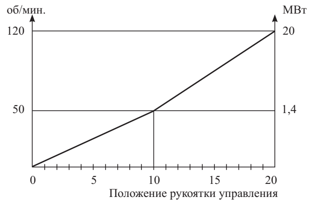
Рис. 2. Диаграммы изменения частоты вращения и мощности ГВ в зависимости от положения рукоятки управления
