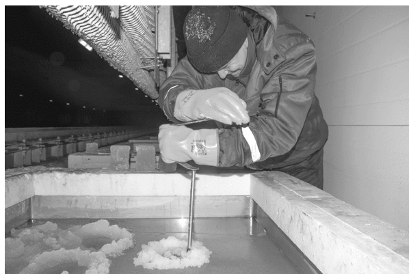
Рис. 3. Выбуривание керна кольцевым буром диаметром 80 мм с укороченной штангой в одном из трех резервуаров
