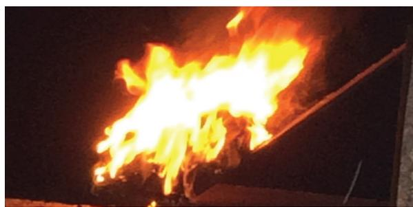
**Рис. 8.** Процесс горения межбортного покрытия типа «Ш» при попадании раскаленного прутка на поверхность
