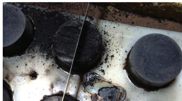
**Рис. 5.** Результат воздействия раскаленного предмета на межбортное покрытие типа «Пластина ГАП»
