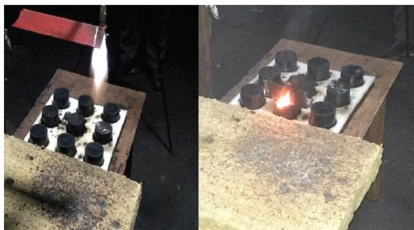
**Рис. 4.** Испытание по определению условий воспламенения образца межбортного покрытия типа «Пластина ГАП» при падении на его поверхность стального уголка
