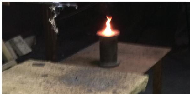
**Рис. 6.** Воздействие раскаленного прутка на поверхность образца межбортного покрытия типа «А»
