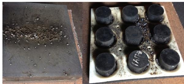
**Рис. 3.** Результаты воздействия раскаленных капель металла на поверхности образцов наружного и межбортного покрытия типа «Пластина ГАП»
