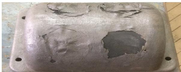
**Рис. 10.** Экспериментальное изделие типа «Ш» с вспенивающимся огнезащитным покрытием SGK-2 после испытаний на герметичность
