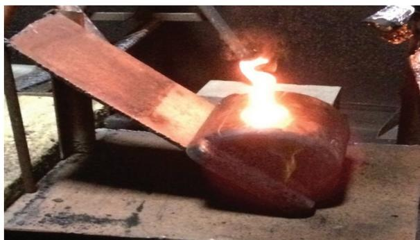
**Рис. 7.** Воспламенение межбортного покрытия типа «Ш» при попадании раскаленного прутка на поверхность
