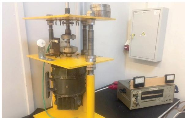
**Рис. 2.** Экспериментальная установка по исследованию работы покрытий в режиме «сухого» трения
