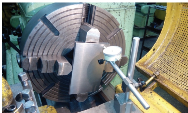
Рис. 5. Установка заготовки клиновой подкладки в четырехкулачковом патроне токарного станка
