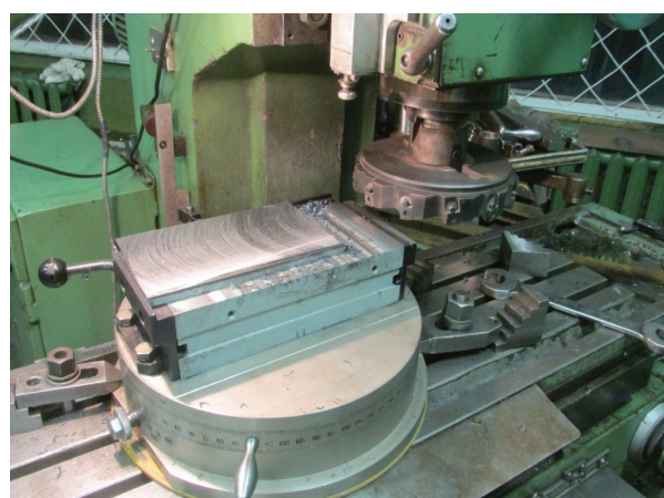
Рис. 7. Размещение устройства для обработки клиновых подкладок на столе фрезерного станка
