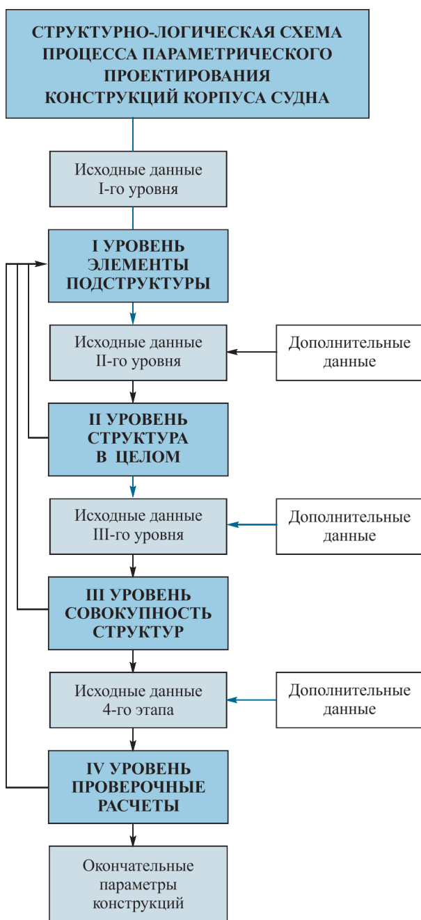
Рис. 2. Модель автоматизированного параметрического проектирования
