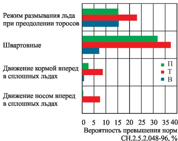
Рис. 14. Вероятность превышения санитарных норм вибрации в спальнях помещений 4-го яруса надстройки при движении во льдах в вертикальном (В), траверзном (Т) и продольном (П) направлениях
