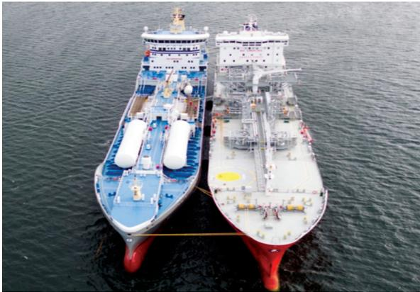
**Рис. 6.** Передача бункерного СПГ между малым газовозом Coral Energy (слева) и нефтяным танкером MT Ternsund (справа), проведенная методом «борт-к-борту» на рейде порта Гетеборг, Швеция [11]
