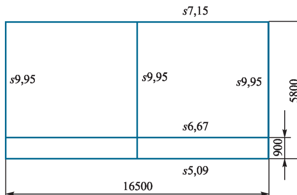
Рис. 3. Приведенные толщины обшивки и настилов в расчетной схеме корпуса т/х «Волгонефть»
