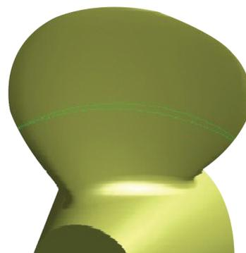
Рис. 8. Лопасть ГВ с цилиндрическим сечением
