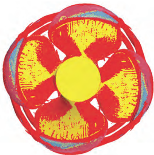
Рис. 3. Результаты расчета кавитации гребного винта на швартовом режиме
