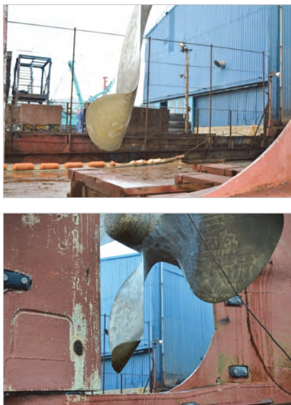
Рис. 1. Характерные повреждения гребных винтов с саблевидными лопастями после контакта со льдом
