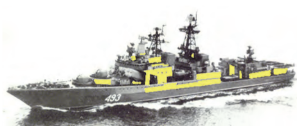
Рис. 2. Предполагаемое размещение радиопоглощающих материалов на корабле
