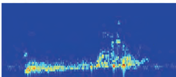
Рис. 17. 3D ИСАР-портрет вспомогательного судна – распределение «блестящих точек» по длине и высоте
