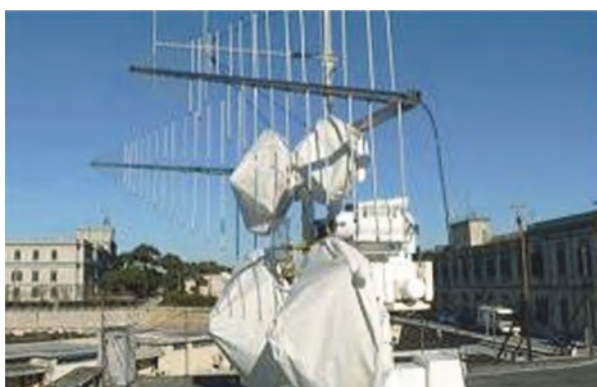
Рис. 16. Измерительные радары диапазона 2–40 ГГц норвежской фирмы ISPAS (а) и итальянской фирмы IDS (б)
