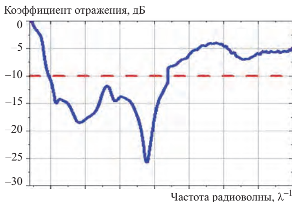
Рис. 7. Спектральная зависимость коэффициента отражения двухслойной метаматериальной структуры
