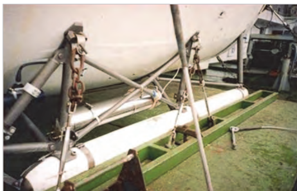
Рис. 2. Размещение погружного гамма-спектрометра ЭКО-5 на борту глубоководного аппарата «МИР»
