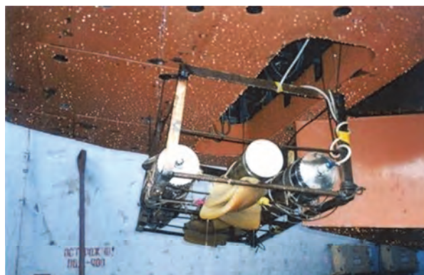
Рис. 3. Размещение погружного спектрометра ЭКО-5 на борту спасательного аппарата АС-34
