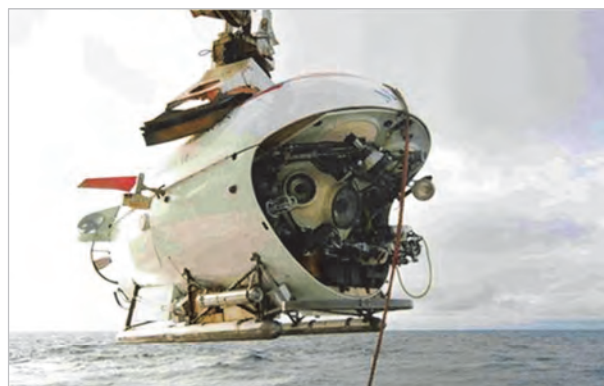
Рис. 1. Глубоководной аппарата «МИР» с погружным гамма-спектрометром ЭКО-5
