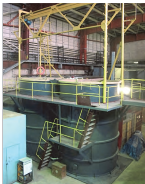
Рис. 8. Стенд «ГРАД-М» для калибровки и поверки погружных радиометров и спектрометров
