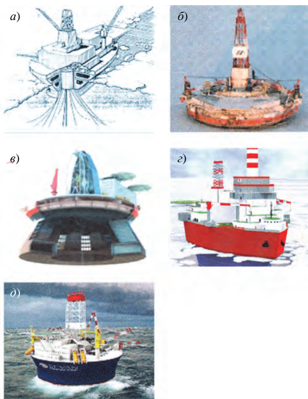
Рис. 1. Типы плавучих буровых установок для круглогодичной эксплуатации в Арктике: а) судно яйцеобразной формы; б) установка с корпусом в виде тела вращения (ЛПБУ Kulluk); в) полупогружная плавучая буровая установка JBF ARCTIC (опорное основание показано в разрезе); г) ЛПБУ клиновидной формы (концепция ЛПБУ ЦКБ «Коралл»); д) установка с корпусом в виде тела вращения (ЛПБУ Sevan)
