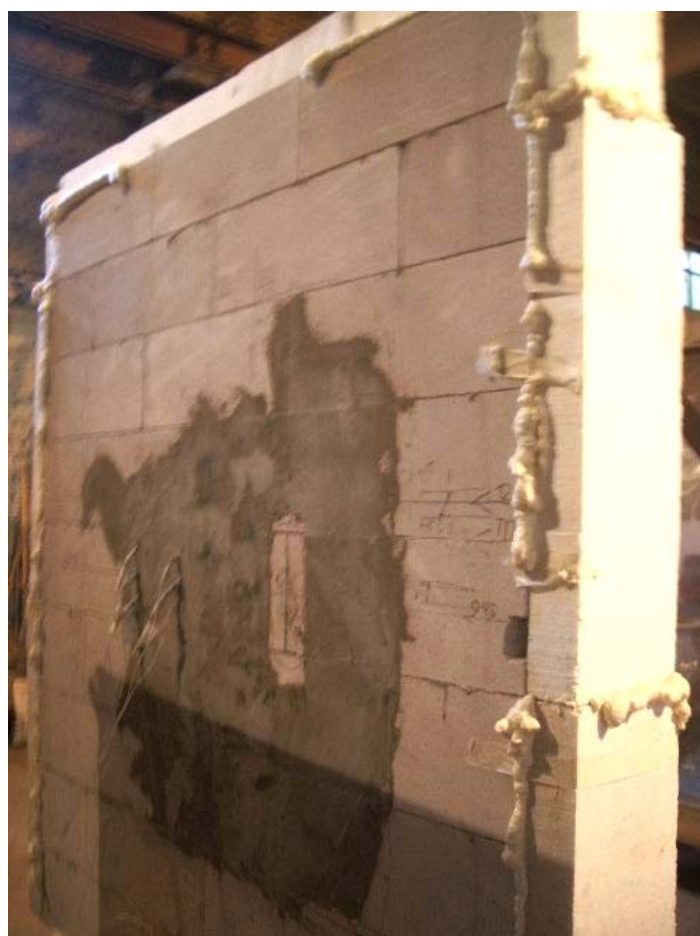
Рисунок 2. Фрагмент стены из пазогребневых блоков при проведении теплофизических испытаний
